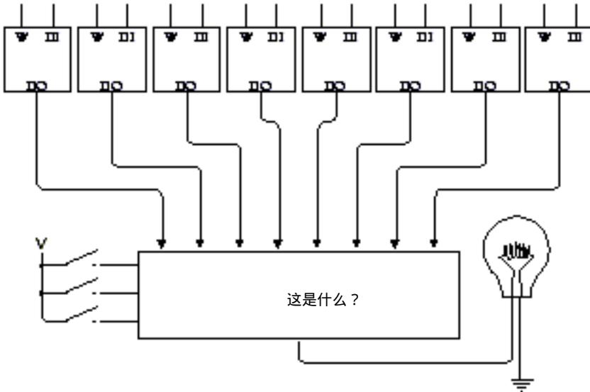
这个“其他东西”就是标识为“这是什么？”的神秘盒子，它上面有8个输入端，左侧有3个输入端。通过闭合和断开这三个开关，就可以从8个输入中选择一个，使其经过底部至输出端输出，该输出使灯泡发光。
