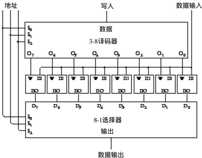
注意，译码器和选择器的三个选择信号相同，现在这三个信号都记作地址（Address）。就像信箱号一样，3位地址决定了选择8个锁存器中的哪一个。在输入端，地址输入决定写入信号触发哪一个锁存器来存储输入的数据。在输出端（图的下部），地址输入控制8-1选择器选择8个锁存器中的一个进行输出。
