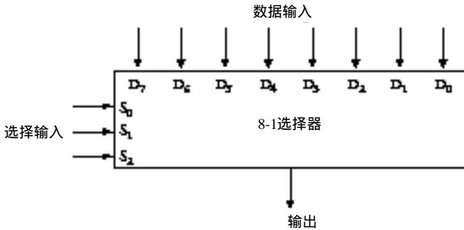
8-1选择器具有8个数据输入端（显示在上部）和3个选择输入端(Select Input)（显示在左侧），选择输入端用于选择哪个输入数据在输出端输出。例如，若选择输入端为000，则输出 $D_0$ 的值；若选择端为111，则输出 $D_7$ 的值；若选择端为101,则输出 $D_5$ 的值。其逻辑表如下：
