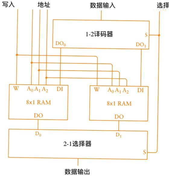
连接到译码器和选择器的选择 ( Select ) 输入实质上选择两个  $8 \times 1$  RAM 阵列中的一个，在这里它也就是第4根地址线。所以，该图实际上是一个  $16 \times 1$  RAM 阵列：
