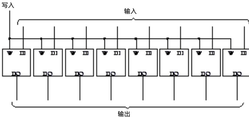
该 8 位锁存器具有 8 个输入端和 8 个输出端。另外，这个锁存器有一个写入输入端，通常为 0。要在这个锁存器中存储一个 8 位二进制数，应将写入信号先置 1 后置 0。也可以把这个锁存器画成一个整体，就像这样：
