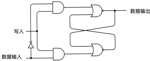
这是同一个触发器，但现在 Q 输出端命名为数据输出 (Data Out)，时钟输入端 (在第 14 章是作为保持位) 命名为写入 (Write)。就像可以在纸上记录信息一样，写入信号使得数据输入 (Data In) 信号写入或存储到电路中。通常，若写入信号 (W) 为 0，则数据输入 (DI) 信号对输出无影响。而当我们想在触发器中存储数据输入信号时，写入信号应先置 1 后置 0。就像在第 14 章提到的，这种类型的电路也叫锁存器，因为它锁定数据。下面画出了一个 1 位锁存器，但没有画出其所包含的单个部件：
