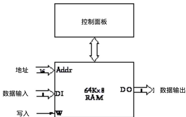
当接管开关闭合时，可用 16 个地址开关来选择 65 536 个地址中的任何一个，而灯泡将显示当前地址中所存的 8 位数据。可用 8 个数据开关来定义一个新数，并通过写入开关把它写入存储器中。
