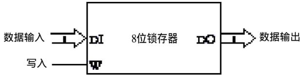
另外一种集成8个1位锁存器的方法不像上述这么直接。假设只想用一个数据输入信号端和一个数据输出信号端，且又希望它具备在一天或一分钟内存储8次数据输入信号的能力。同时，也希望能够通过检测这个数据输出信号端就可以检查这8个数据。
