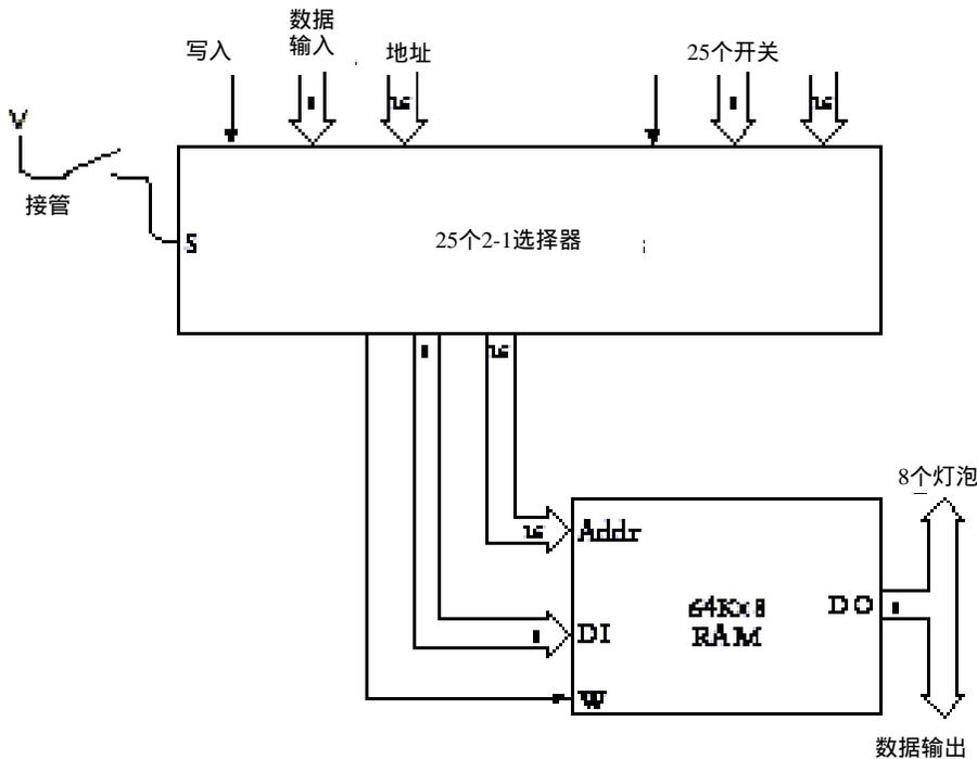
当接管开关断开时 ( 如上图 )，64K × 8 RAM阵列的地址、数据输入和写入信号来自于外部信号，显示在2-1选择器的左上角；当接管开关闭合时，RAM阵列的地址、数据输入和写入信号来自于控制面板开关传来的信号。无论哪种情况，RAM阵列的数据输出信号传到8个灯泡上或其他可能的地方。
