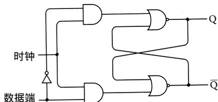
当时钟输入为 1 时，Q 端输出与数据端输入是相同的。但当时钟输入变为 0 时，Q 端输出将维持原来的数据端输入，再改变数据端输入不会影响 Q 端输出，直到时钟输入再次变为 1 为止。触发器的逻辑表格如下：
