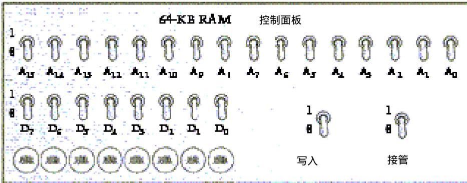
所有的开关均显示在0位置。另外，还有一个标识为接管 (takeover)的开关，使用这个开关的目的是使其他电路可以使用与控制面板相连的同一个存储器。当接管开关置0时( 如图所示 )，控制面板上的其余开关将不起任何作用；而当此开关置 1时，控制面板将对存储器进行专门控制。
